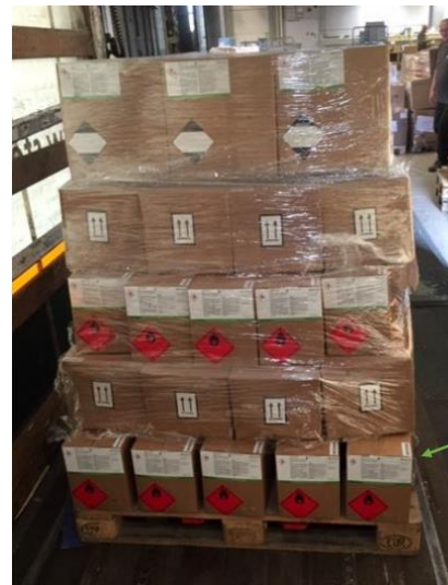
10. Onderste rij niet geseald (waardoor dozen erboven konden schuiven) en verkeerd gestuwd
