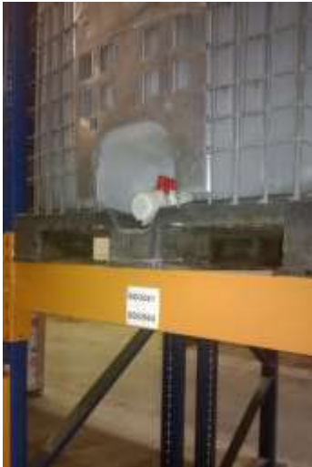
Voorbeeld van een IBC met "open" pallet in een stelling.
